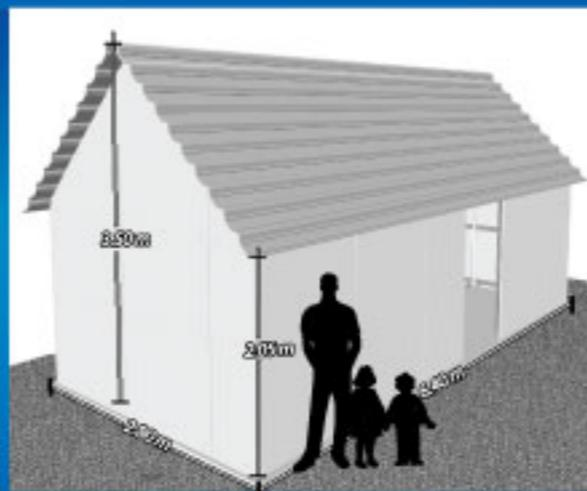
Los albergues están formados por una estructura de PVC de 2" y madera como refuerzos horizontales y un techo de lámina de Aluzinc. Además, tenemos disponibilidad en tres tipos de cubierta o forro: Fibrocemento, PVC y aislante térmico, permitiendo así adaptar el albergue a la economía del cliente.
